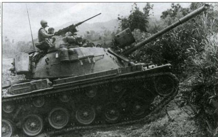
Танк М48А2С 5-й пехотной дивизии Армии США преодолевает препятствие. На стволе пушки установлен ксеноновый прожектор, неплохо зарекомендовавший себя во Вьетнаме
