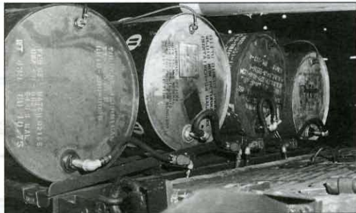
Закрепленная на корме танка консольная платформа с четырьмя 200-л топливными бочками позволила увеличить запас хода, но была крайне уязвимой для огня даже легкого стрелкового оружия
