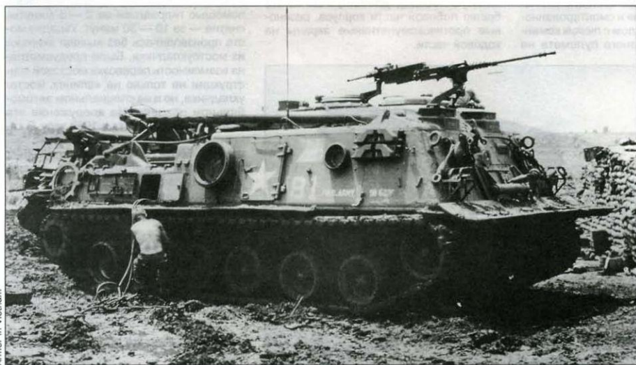
БРЭМ М88 10-го бронекавалерийского полка армии США во Вьетнаме. На многих машинах этого типа на крупнокалиберный пулемет надевали коробчатый броневой щит
