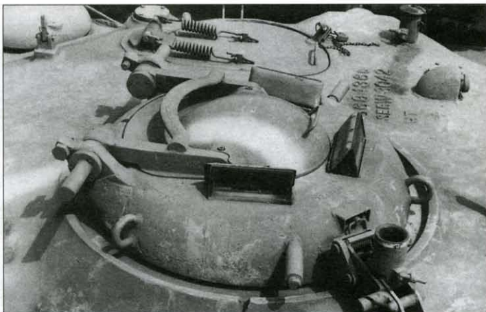
Командирская башенка «Урдан» израильской конструкции. На переднем плане — кронштейн крепления единого пулемета M60
