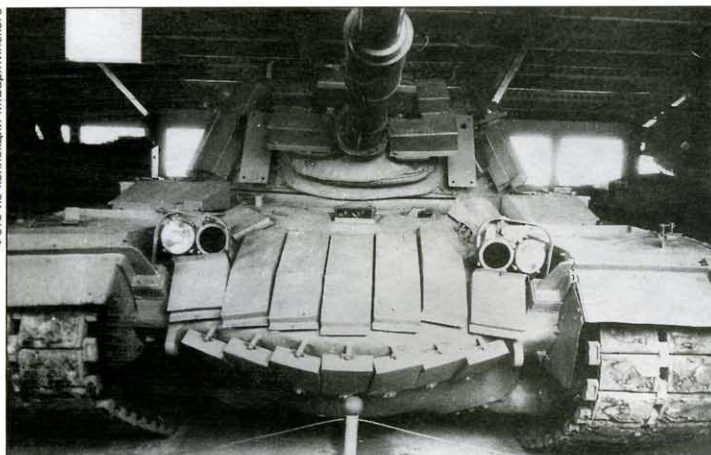
Израильский М48, оборудованный комплектом динамической защиты «Блейзер», находится в танковом музее в Кубинке
