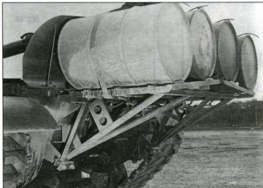
Закрепленная на корме танка консольная платформа с четырьмя 200-л топливными бочками позволила увеличить запас хода, но была крайне уязвимой для огня даже легкого стрелкового оружия
