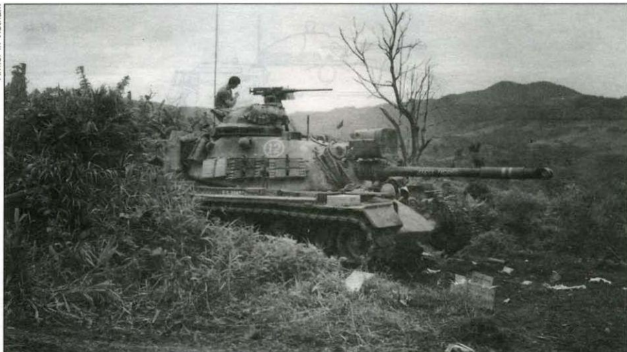
M48A3 5-й мотопехотной дивизии на боевой позиции. Американские танкисты часто укрепляли крупнокалиберный пулемет M2HB снаружи командирской башенки, что обеспечивало большую эффективность огня
