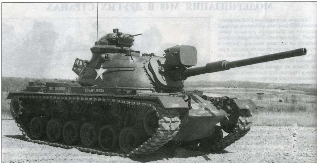
Один из первых образцов M48A5 во время испытаний. На этой машине еще сохранена командирская башенка M1
